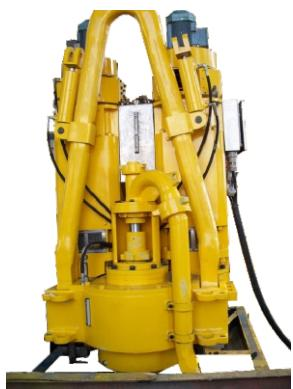
石油钻机顶驱液压系统
